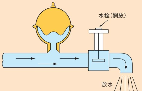
水栓が急閉止されると、水がミニトロールの中に流入し、ダイヤフラムを介して封入空気が圧縮され水撃が防止・軽減されます。
